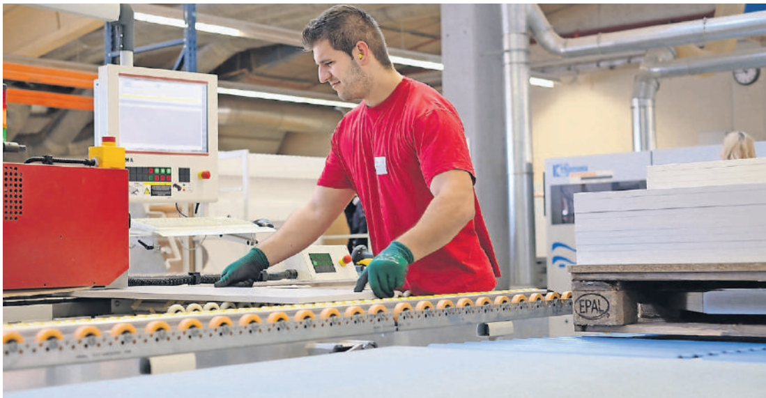
Mitarbeiter Shkodran Iljazi bedient eine Kantenleimmaschine beim Büromöbelproduzenten Haworth Schweiz AG in Menziken.
