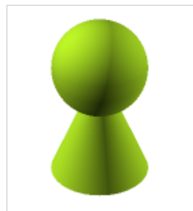
Abbildung 7: Nach Vereinigen der beiden Körper
